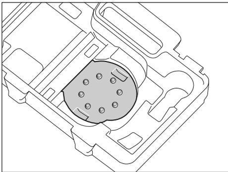
Для удобного выравнивания шлифовального листа **6** на шлифовальной тарелке **5** Вы можете использовать приспособление в инструментальном чемодане, показанное на рисунке. Вложите в приспособление шлифовальный лист липучкой наверх и прижмите с усилием электроинструмент шлифовальной тарелкой к листу.
