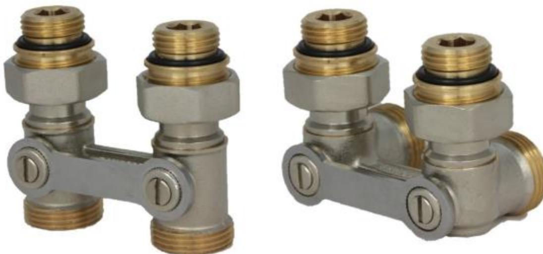
Клапаны запорные предназначены для применения в двухтрубных насосных системах водяного отопления с целью отключения отдельного отопительного прибора для его демонтажа или технического обслуживания без опорожнения всей системы. Не предназначены для контакта с питьевой водой в системах хозяйственно-питьевого водоснабжения.
