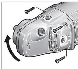
Редукторная головка может поворачиваться с интервалом в 90°. Таким образом выключатель может быть установлен в удобное для работы положение, например, для отрезных работ с вытяжным колпаком и направляющими салазками **24** или для левши.
