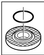
На опорном фланце **7** вокруг центрирующего буртика находится пластмассовая деталь (кольцо круглого сечения). Если кольцо круглого сечения отсутствует или повреждено, опорный фланец **7** необходимо обязательно заменить перед дальнейшим применением.
