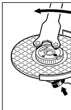
Правильно закрепленную, не имеющую повреждений быстрозажимную гайку Вы можете отвернуть, вращая рукой кольцо с накаткой против часовой стрелки. Никогда не отворачивайте прочно сидящую быстрозажимную гайку клещами, а пользуйтесь ключом для гаек с двумя торцовыми отверстиями. Накладывайте ключ для гаек с двумя торцовыми отверстиями согласно рисунку.
