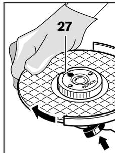
Для фиксации шлифовального шпинделя нажмите кнопку фиксирования шпинделя **1**. Для затягивания быстрозажимной гайки поверните шлифовальный круг с усилием по часовой стрелке.
