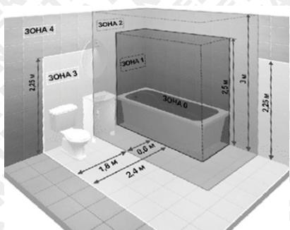
Запрещается размещать водонагреватель в зоне 1, не рекомендуется размещать в зоне 2. Не допускается установка электрической розетки питания в зонах 1,2,3. Розетка электропитания должна быть надежно закреплена на стене, не допускается использование удлинителей.
