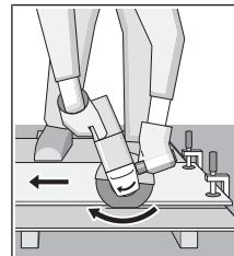
Всегда ведите электроинструмент против направления вращения. В противном случае существует опасность **не-контролированного** вырываивания инструмента из прорези. При резке профилей или четырехгранных труб начинайте рез на наименьшем поперечном сечении.
