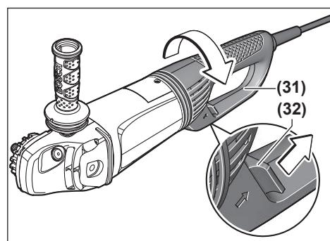
Главную рукоятку (31) можно повернуть относительно корпуса двигателя на 90° влево или вправо. Таким образом выключатель может быть установлен в удобное для работы положение, например, для отрезных работ с вытяжным колпаком и направляющими сапогами (21) или для левши.
