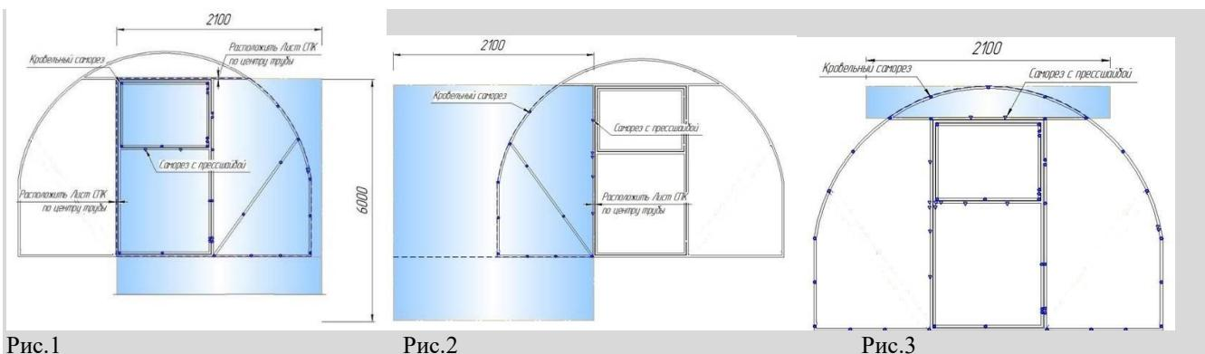
Установите петли на дверь и форточку с помощью саморезов. Все петли должны находиться снаружи поликарбоната. Прикрутите саморезами завертки на форточку и дверь, как показано на рис. 3. Затем в прикрепленном к торцу листе СПК необходимо вырезать дверь вдоль стойки дверного проема с навесами между рамкой двери и аркой дверного проема, а в нижней части двери лист должен полностью закрывать порог. Форточка вырезается по середине наружной рамки.
