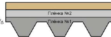
Рис. 18. Тыльная сторона гонта гибкой черепицы Дöске.
