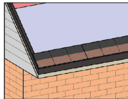
Рис. 16. Схема укладки карнизной черепицы на карниз.
