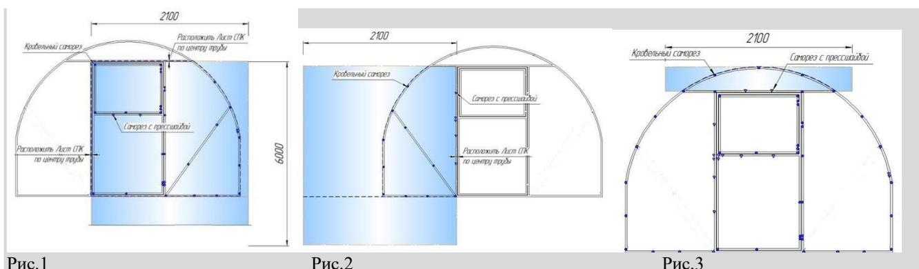
Установите петли на дверь и форточку с помощью саморезов. Все петли должны находиться снаружи поликарбоната. Прикрутите саморезами заготовки на форточку и дверь, как показано на рис. 3. Затем в прикрепленном к торцу листе СПК необходимо вырезать дверь вдоль стойки дверного проема с навесами между рамкой двери и аркой дверного проема, а в нижней части двери лист должен полностью закрывать порог. Форточка вырезается по середине наружной рамки.
