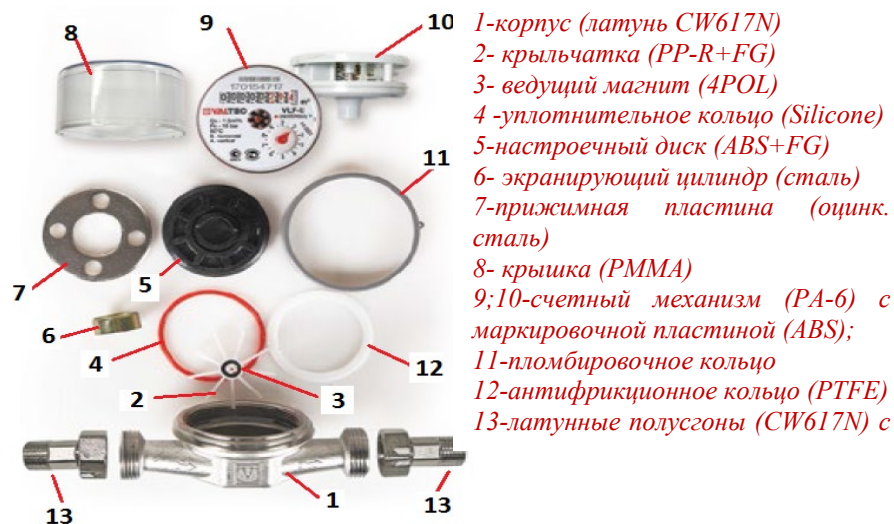
Рис.1 Конструкция счетчика в разобранном виде
