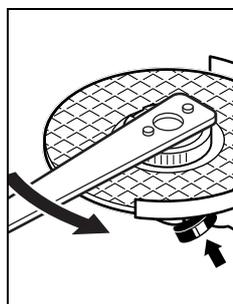
Закрепленную надлежащим способом, неповрежденную быстрозажимную гайку можно открутить вручную, повернув кольцо с накаткой против часовой стрелки.
