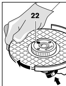
Для фиксации шлифовального шпинделя нажмите кнопку фиксирования шпинделя **1**. Для затягивания быстрозажимной гайки поверните шлифовальный круг с усилием по часовой стрелке.
