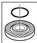
**Посадочный фланец для шпинделя **М 14**:** На опорном фланце **9** вокруг центрирующего буртика находится пластмассовая деталь (кольцо круглого сечения). Если кольцо круглого сечения отсутствует или повреждено, опорный фланец **9** необходимо обязательно заменить перед дальнейшим применением.
