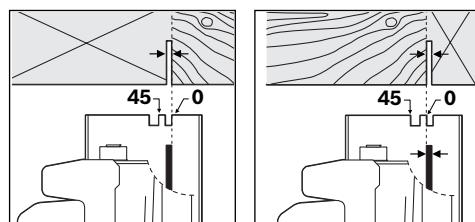
Метка угла пропила  $0^\circ$  (**9**) показывает положение пильного диска при распиле под прямым углом. Метка угла пропила  $45^\circ$  (**8**) показывает положение пильного диска при распиле под углом  $45^\circ$ .
